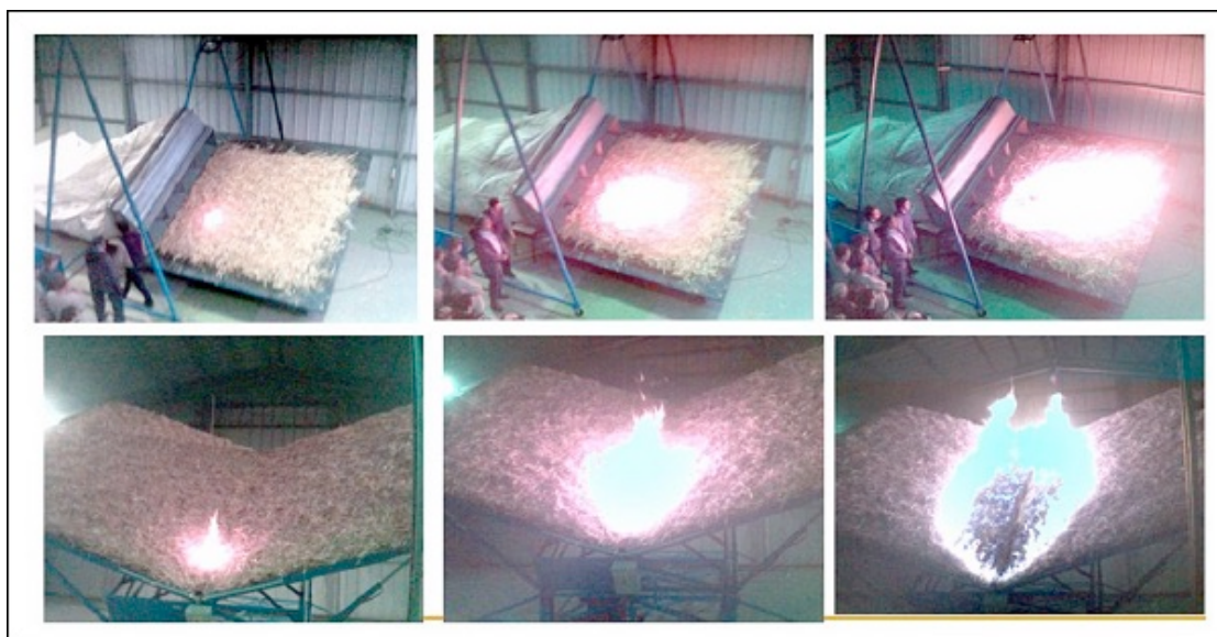
Slika 9. Primjer laboratorijskog eksperimenta eruptivnog širenja požara u laboratoriju u Louisi.
